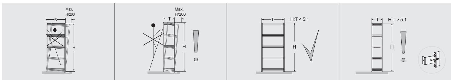
**D** Beachten Sie bitte, dass die Stützrahmen senkrecht stehen. Eine Abweichung um ein Zweihundertstel der Höhe kann toleriert werden, ggf. sind Unterlegplatten erforderlich. Als standsicher gelten von Hand be- und entladene Regale, wenn der Wert: Höhe geteilt durch Tiefe kleiner oder gleich 5 ist. Falls das Ergebnis größer als 5 ist, sind die Regale durch geeignete Maßnahmen zu sichern. Sollten Sie bezüglich der erforderlichen Sicherungen Fragen haben, rufen Sie uns bitte an.
