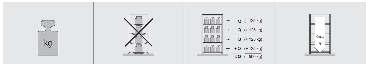
**D** Die angegebenen maximalen Tragfähigkeiten für Fachböden [Q] gelten bei jeweils gleichmäßig verteilter Last. Die Summe der Fachlasten [ $\Sigma Q$ ] in einem Regalfeld muss kleiner gleich der unten angegebenen Feldlast [Qmax.] sein. Bei Aufstellung von weniger als 3 Regalfeldern reduziert sich die jeweils angegebene Feldlast um 10%. Der Gesamtschwerpunkt darf in jedem Fall nicht über der halben Regalhöhe liegen.
